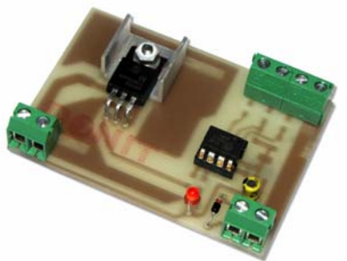
Obr.4. Osadená DPS, vrchná strana
